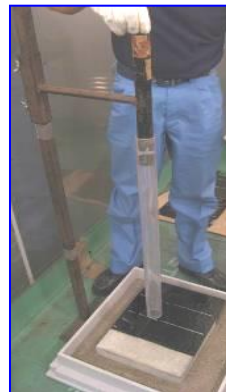
図 1.耐衝撃性試験状況
