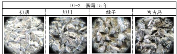
図2 DI-2 15年暴露試験体の表面状態の画像
