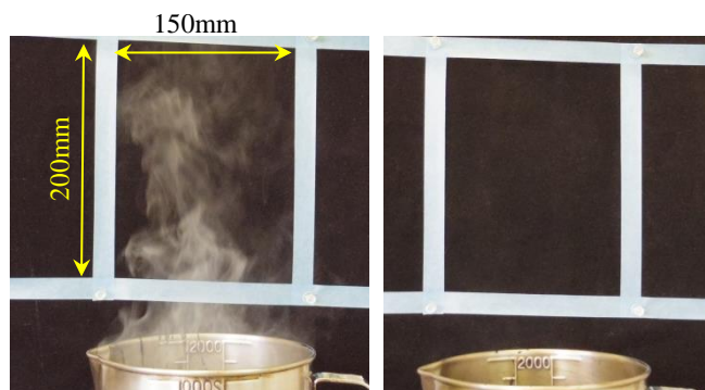
左：工事用73種 280℃ / 右：低温溶融型①230℃ 図3. 発煙部位の撮影実例(写真)
