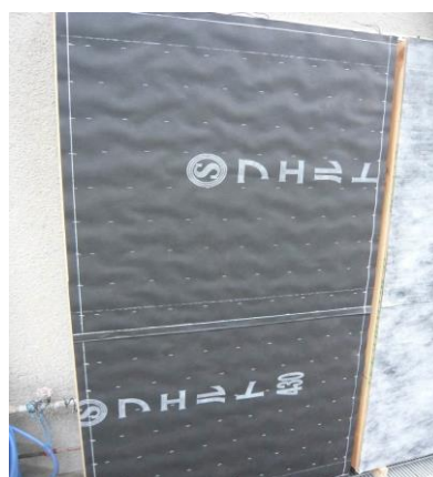
写真3 屋外暴露試験における試験体Aの変形状況
