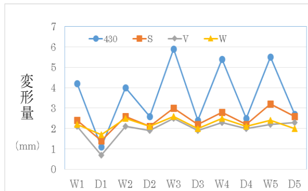
図2 促進ふくれ試験による防水紙の変形量
