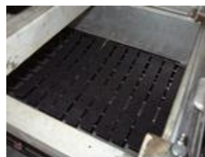
写真1 低温恒温槽内に養生
