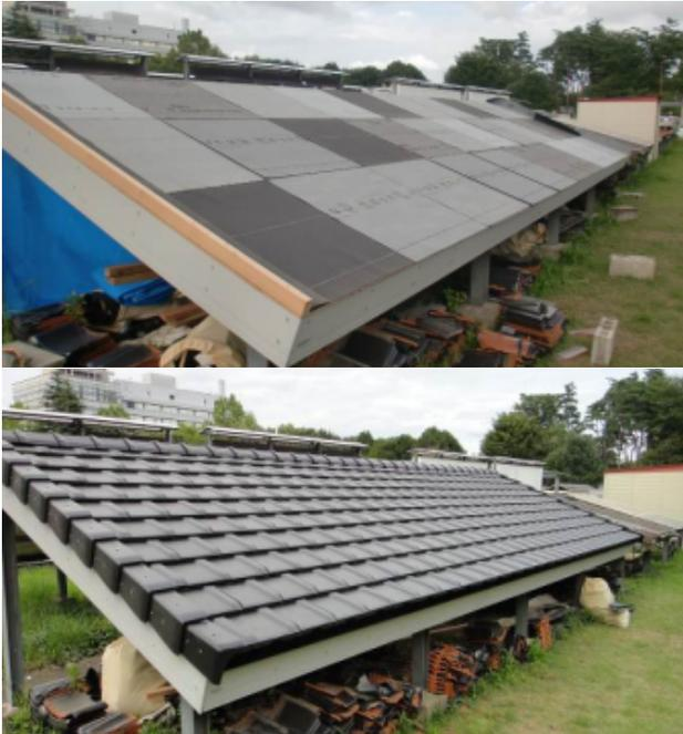
図1 暴露試験の様子(上:下葺き材施工、下:屋根材施工)
