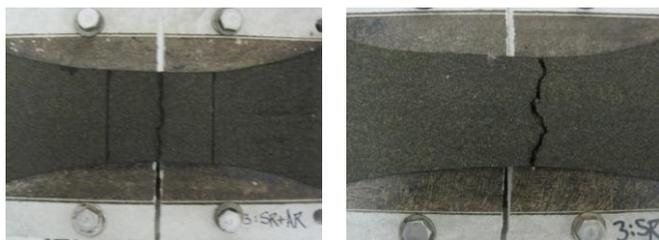
写真 2.3 試験後の試験体状況 (周期の違い)
