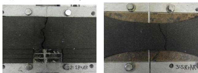
写真 3.4 試験後の試験体状況 (形状の違い)
