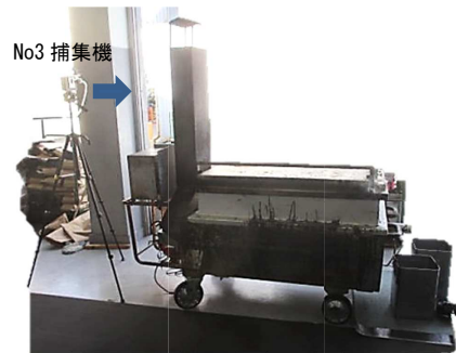
写真 3. 溶融釜と No.3 捕集機およびガス検知管
