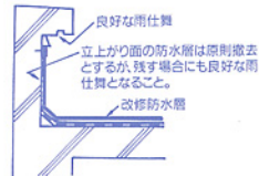
(2) 露出防水の立上がり面の措置
