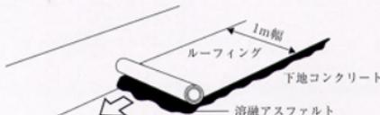
注) アスファルトルーフィング\*：合成繊維不織布や有機繊維を基材として、溶融アスファルトを工場で含浸塗覆した、一定厚さのシート状の防水材料
