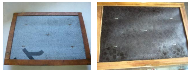
写真2 防水紙の変形状況
