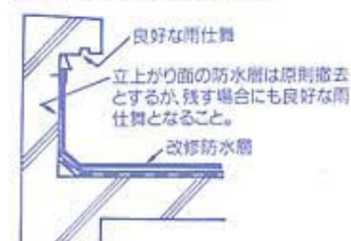
(2) 露出防水の立上がり面の措置
