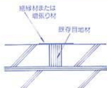
(1) 既存目地材を残す。
