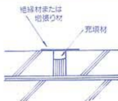
(2) 既存目地材の欠損部に充填材を詰める。
