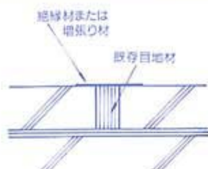
(1) 既存目地材を残す。
